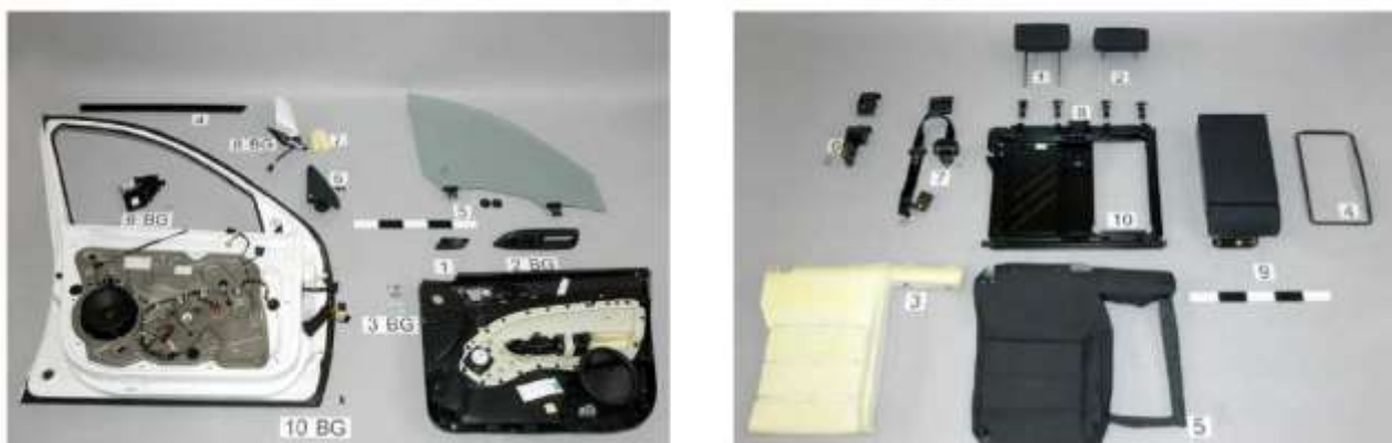
Instrukcja demontażu – przykład dotyczący przednich drzwi i podłokietnika tylnego siedzenia Octavii.
